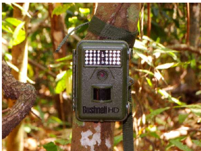
Foto 4.1-2: Exemplo de armadilha fotográfica modelo Bushnell HD
