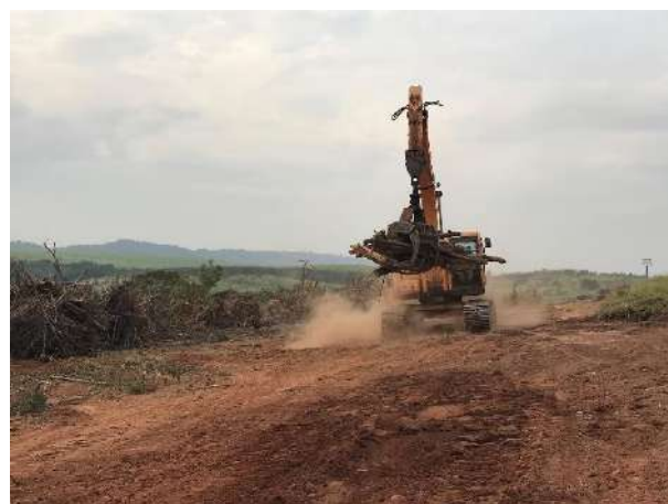
Foto 26 – Escavadeira garra realizando o baldeio do material florestal (Registro fotográfico 17/05/2021).
